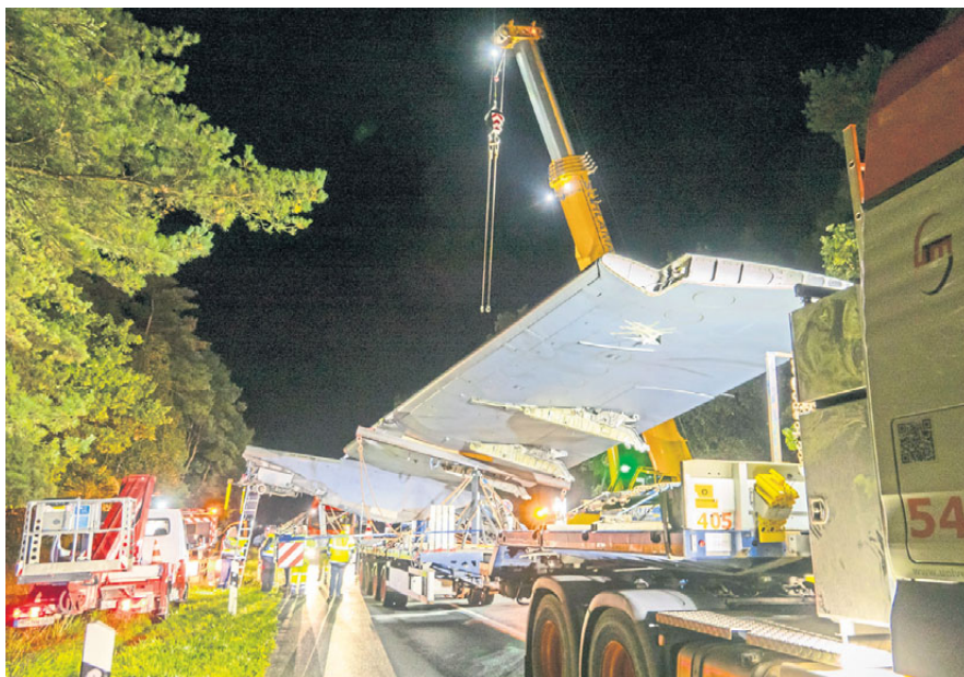
Schwertransport bei Nacht: Die beiden mächtigen Tragflächen des Airbus A 310 müssen für das letzte Teilstück der Strecke mithilfe eines Spezialkrans aufgerichtet werden. Fotos: mü
